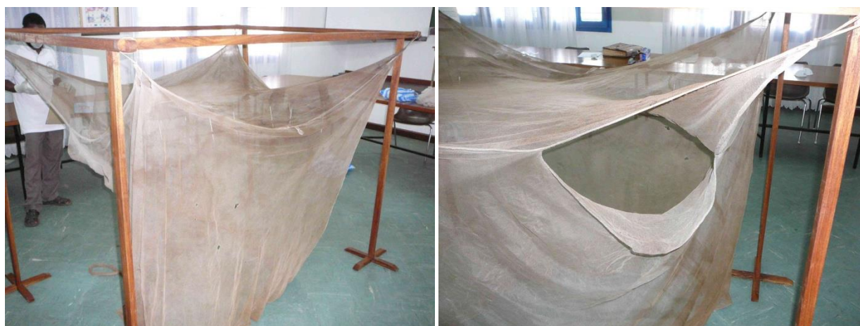
Figure 1. Moustiquaires usagées installées sur un cadre pour le comptage des trous de différentes tailles.
